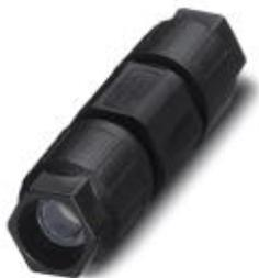
QUICKON-Leitungsverbinder, schwarz, 4-polig ohne PE, 0,75 mm<sup>2</sup> ... 1,5 mm<sup>2</sup> / 500 V / 15 A, für Kabeldurchmesser 6 mm ... 12 mm.
