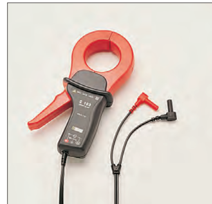
Zangenstromwandler für direkte AC- und DC-Strommessungen von 0,1 mA bis 3600 A an Anlagen im Betrieb, ohne Stromkreisunterbrechung. Siehe S. 46
