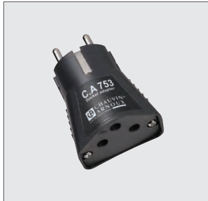
C.A 753 Adapter zur Messung an Schutzkontakt-Steckdosen _____ P01191748Z Geeignet für alle Prüfspitzen (2 und 4 mm \phi , IP2X,...) Erkennung Außenleiter / Neutraleiter IEC 61010 230 V CAT II
