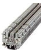
Grundklemmenblöcke mit beidseitigem Prüfabgriff und potenzialgleichen Doppelanschlüssen für NS 32 und NS 35/7,5 Tragschiene, mit Abschlussdeckel, für Stecker ST-REL..., ST-OV... und ST-OE..., 3-polig
