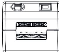
Sekundäre Zugentlastung für Kabel mit kleinerem Kabelmantel
