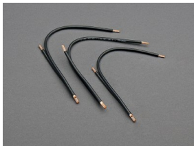
32915 Doppelleitung 2x AWG 10 (2x 6 mm 2 ), 130 / 280 mm lang
