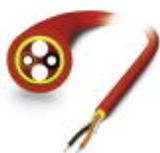
Konfektionierbare, robuste POF-Installationsleitung für die feste Verlegung im Innenbereich. Ausgelegt für erhöhte Anforderungen an Zug- und Querdruckbelastungen, mit Einzelementen aus hochstrapazierfähigem Polyamid (PE). Die Leitung ist halogenfrei, Ozon- und UV-beständig mit verstärktem Polyurethan (PUR) Außenmantel.
