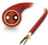
Konfektionierbare, hochflexible POF-Rundleitung für den Einsatz in Schleppketten für eine Wechselbiegehäufigkeit von bis zu 5 Mio. Zyklen mit Einzelementen aus hochstrapazierfähigem Polyamid (PE). Die Leitung ist halogenfrei, Ozon- und UV-beständig mit robustem Polyurethan (PUR) Außenmantel.
