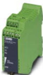
LWL-Konverter mit integrierter optischer Diagnose, Alarmkontakt, für RS-422/RS-485-4-Draht/ INTERBUS bis 2 MBit/s, Endgerät mit einer LWL-Schnittstelle (FSMA), 660 nm, für Polymer-/PCF-Faserkabel
