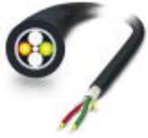
Konfektionierbare, hochrobuste PCF-Rundleitung (nur IP20-Köpfe) für die Außenverlegung mit integrierter Dampfsperre, sowie nagetierfester Glasgarnlage. Einzelelemente aus hochflexiblem FRNC-Material. Die Leitung ist Ozon- und UV-beständig mit sehr robustem Polyethylen-Außenmantel.
