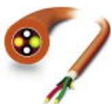
Konfektionierbare, robuste PCF-Installationsleitung (nur IP20-Köpfe) für Verlegung in stationären Anlagen und Maschinen, Aramid-Zugentlastungselemente, Einzelemente aus FRNC-Material, halogenfrei, Ozon- und UV-beständig, mit Polyurethan-(PUR)-Außenmantel
