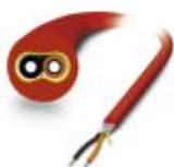
Konfektionierbare POF-Installationsleitung (nur IP20-Köpfe) für Verlegung in stationären Anlagen und Maschinen, Einzelemente aus Polyamid (PE), halogenfrei, Ozon- und UV-beständig, mit Polyurethan-(PUR)-Außenmantel
