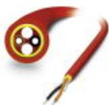
Konfektionierbare, robuste POF-Installationsleitung (nur IP20-Köpfe) für Verlegung in stationären Anlagen und Maschinen, Einzelemente aus Polyamid (PE), halogenfrei, Ozon- und UV-beständig, mit verstärktem Polyurethan-(PUR)-Außenmantel
