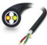
Konfektionierbare, hochrobuste PCF-Rundleitung (nur IP20-Köpfe) für die Außenverlegung mit integrierte Dampfsperre, sowie nagetierfeste Glasgarnlage. Einzelemente aus hochflexiblem FRNC-Material. Die Leitung ist Ozon- und UV-beständig mit sehr robustem Polyethylen-Außenmantel.
