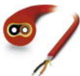
Polymerfaserkabel, duplex 980 µm /1000 µm, mittelschwere Ausführung für die Verlegung in stationären Anlagen und Maschinen, Meterware ohne Stecker
