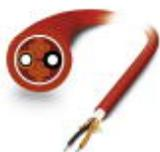
Konfektionierbare, hochflexible POF-Rundleitung für den Einsatz in Schleppketten für eine Wechselbiegehäufigkeit von bis zu 5 Mio. Zyklen mit Einzelelementen aus hochstrapazierfähigem Polyamid (PE). Die Leitung ist halogenfrei, Ozon- und UV-beständig mit robustem Polyurethan (PUR) Außenmantel.
