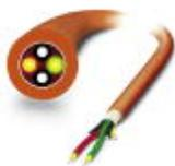
Konfektionierbare, robuste PCF-Installationsleitung für den Innenbereich mit hochreißfesten Aramid-Zugentlastungselementen. Einzelemente aus hochflexiblem FRNC-Material. Die Leitung ist halogenfrei, Ozon- und UV-beständig mit robustem Polyurethan (PUR) Außenmantel.
