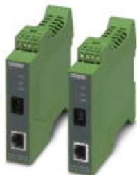
LWL-Konverter-Set, bestehend aus Gerät Typ A und Gerät Typ B, zur Vollduplex-Übertragung von 10/100BASE-T(X) auf einzelne Simplex-Glasfaser mit WDM (Wavelength Division Multiplex) Technologie. SC-Simplex-LWL-Anschluss (1550/1310 nm)
