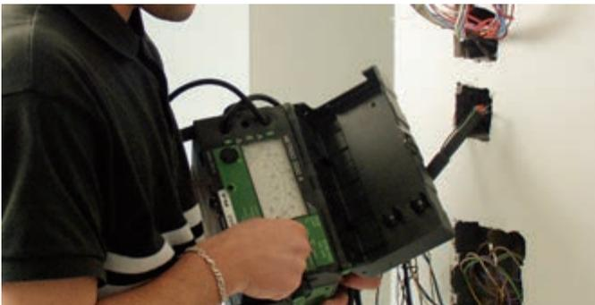
Nach der Auslegung und nach der Fertigstellung des Bodenbelages ist Laminotherm auf Durchgang, Widerstand und Isolationswert zu prüfen.
