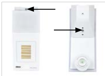
Abb. 6 Lösen Sie die beiden Schrauben an Deckel (oben) und Unterteil (unten) mit einem Torx-Schraubendreher der Größe 6.
