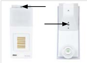
Abb. 16 Verschrauben Sie Deckel (oben) und Unterteil (unten).
