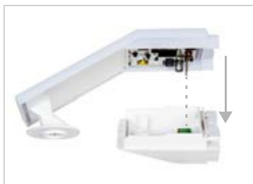
Abb. 14 Stecken Sie den Deckel auf das Unterteil. Dabei wird die Steckverbindung zwischen der Platine im Deckel und der Anschlussbuchse im Unterteil hergestellt.
