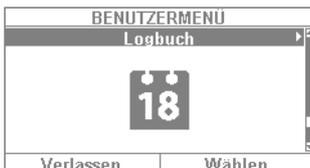
In diesem Menü können Sie das so genannte „Logbuch“ auslesen. Im Logbuch werden sämtliche für die Alarmzentrale relevanten Daten samt Datum und Uhrzeit gespeichert. Der Speicher umfasst max. 600 Einträge. Ist der Speicher voll, wird das jeweils älteste Ereignis gelöscht und durch den neuen Eintrag ersetzt („FiFo-Prinzip“: First in – first out).
