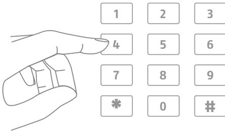
Durch die direkte Eingabe eines Benutzercodes kann die Anlage scharf geschaltet werden. In Absprache mit Ihrem Facherrichter wurde die Anlage entweder mit einem 4- oder 6-stelligen Benutzercode konfiguriert. Der Standard-Benutzercode lautet „1234“ oder, bei 6-stelliger Einstellung, „123456“.
