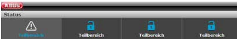
Um die Zentrale zurückzusetzen, wählen Sie anschließend das Symbol „!“ , das nach der Quittierung im ausgelösten Teilbereich erscheint. Auch diese Aktion muss mittels einer Rückfrage der Zentrale bestätigt werden.
