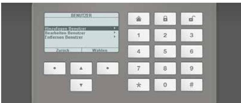
Im Menüpunkt „**Tastatur**“ finden Sie die Funktion „**Virtuelles Bedienteil**“. Mit dieser können Sie über das Webinterface das Menü der Secvest darstellen und z. B. einem eben angelegten Benutzer noch eine Fernbedienung zuordnen. Steuern Sie hierzu mit der Maus die virtuellen Cursortasten und begeben Sie sich in das Menü „Benutzer“. Dort sehen Sie die weiteren Optionen.
