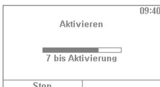
2. Wenn Sie nun die Taste
