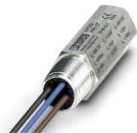
Überspannungsschutz für einen erdpotenzialfrei betriebenen Signalkreis im Anschraubmodul der Schutzart IP67 für Sensorköpfe, Anschluss ½ Zoll 14 NPT. Geprüft nach Zündschutzarten in Ex-Bereichen Ex d / Ex tD / Ex ia IIC / Ex iaD.
