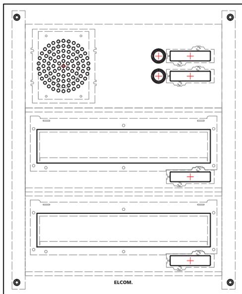
AMT - 2/1 Mauerdurchwurf Briefkasten-Anlage
