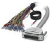
Konfektioniertes, geschirmtes Rundkabel; Anschluss 1: Einzeladern (25-polig) (Die Adern sind beschriftet und mit Aderendhülsen versehen. Das Schirmgeflecht ist auf ein separates Kabelende herausgeführt.); Anschluss 2: D-SUB-Buchsenleiste (1x 25-polig); Kabellänge: 1 m
