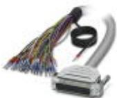
Konfektioniertes, geschirmtes Rundkabel; Anschluss 1: Einzeladern (25-polig) (Die Adern sind beschriftet und mit Aderendhülsen versehen. Das Schirmgeflecht ist auf ein separates Kabelende herausgeführt.); Anschluss 2: D-SUB-Buchsenleiste (1x 25-polig); Kabellänge: 2 m
