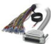
Konfektioniertes, geschirmtes Rundkabel; Anschluss 1: Einzeladern (25-polig) (Die Adern sind beschriftet und mit Aderendhülsen versehen. Das Schirmgeflecht ist auf ein separates Kabelende herausgeführt.); Anschluss 2: D-SUB-Buchsenleiste (1x 25-polig); Kabellänge: variabel
