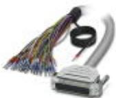
Konfektioniertes, geschirmtes Rundkabel; Anschluss 1: Einzeladern (25-polig) (Die Adern sind beschriftet und mit Aderendhülsen versehen. Das Schirmgeflecht ist auf ein separates Kabelende herausgeführt.); Anschluss 2: D-SUB-Buchsenleiste (1x 25-polig); Kabellänge: 1,5 m
