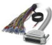
Konfektioniertes, geschirmtes Rundkabel; Anschluss 1: Einzeladern (25-polig) (Die Adern sind beschriftet und mit Aderendhülsen versehen. Das Schirmgeflecht ist auf ein separates Kabelende herausgeführt.); Anschluss 2: D-SUB-Buchsenleiste (1x 25-polig); Kabellänge: 3 m
