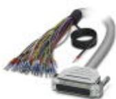
Konfektioniertes, geschirmtes Rundkabel; Anschluss 1: Einzeladern (25-polig) (Die Adern sind beschriftet und mit Aderendhülsen versehen. Das Schirmgeflecht ist auf ein separates Kabelende herausgeführt.); Anschluss 2: D-SUB-Buchsenleiste (1x 25-polig); Kabellänge: 6 m
