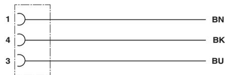
Kontaktbelegung der M12-Buchse
