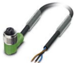
Sensor-/Aktor-Kabel, 3-polig, PUR halogenfrei, schwarzgrau RAL 7021, freies Leitungsende, auf Buchse gewinkelt M12, A-kodiert, Kabellänge: 10 m
