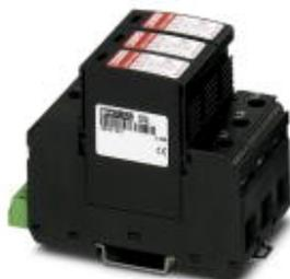
Universeller steckbarer Blitzstrom- / Überspannungsableiter auf Varistorbasis für 3-phasige Stromversorgungsnetze mit gemeinsamem N und PE (4-Leitersystem: L1, L2, L3, PEN), mit Fernmeldekontakt.
