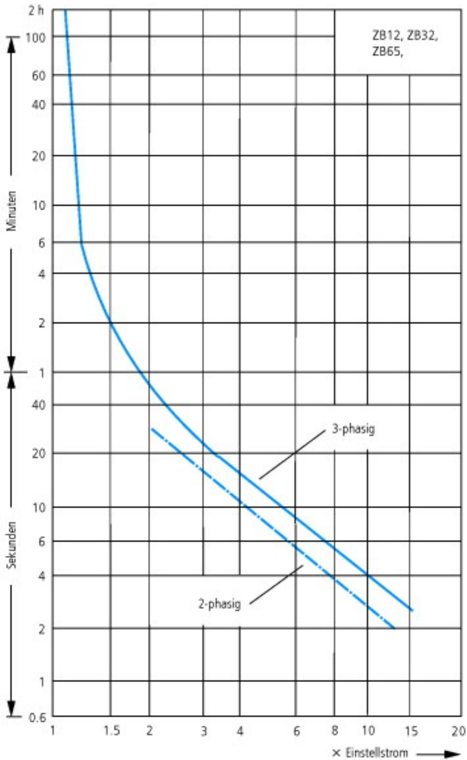
Diese Auslösekennlinien sind Mittelwerte der Streubänder bei 20 °C Umgebungstemperatur vom kalten Zustand aus. Auslösezeit in Abhängigkeit vom Ansprechstrom. Bei betriebswarmen Geräten sinkt die Auslösezeit der Motorschutzrelais auf ca. 25 % des abgelesenen Wertes. Spezifische Kennlinien für jeden einzelnen Einstellbereich im Handbuch
