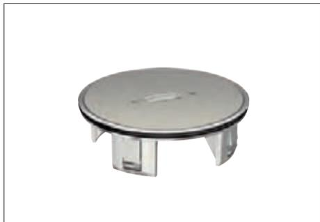
Höhenvariabler Leitungsauslass zum Einbau in Rahmenkassetten RKF sowie in nivellierbaren runden und quadratischen Kassetten RKFR und RKFN. Im genutzten Zustand fußbodenüberterragend, im nicht genutzten Zustand fußbodenbündig. Einsatz in nass gepflegten Fußböden. Tubusabdeckung und Griffbügel aus V2A.
