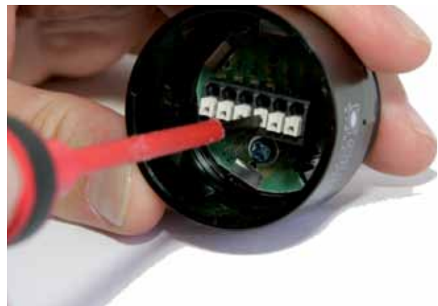
Anschlussklemme mit Push-In Technik (ECOmodul40)
