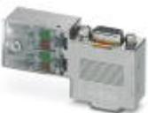
D-SUB-Stecker, 9-polig, Stift, Kabelzuführung unter 90°, Bussystem: PROFIBUS DP bis 12 MBit/s mit PG-D-SUB-Buchse zum Anschluss eines Programmiergeräts, Abschlusswiderstand über Schiebeschalter zuschaltbar, Pinbelegung: 3, 5, 6, 8; IDC-Klemmenanschluss
