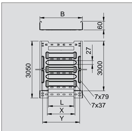
MKSM 60 = Mittelschweres-Kabelrinnen-System-Magic in 60 mm Seitenhöhe. Kabelrinne mit Schnellverbindungs-System, inklusive aller relevanten Verbindungsbauteile zur zeitsparenden und wirtschaftlichen Installation, mit gesickter Längsbohlenlochung 7 x 79 mm zur Auslegermontage. Alle Breiten mit Quersickung zur Stabilisierung und Kabelbelüftung. Durchgängige Seitenlochung 7 x 20 mm als zusätzliche Verbinderlochung.
