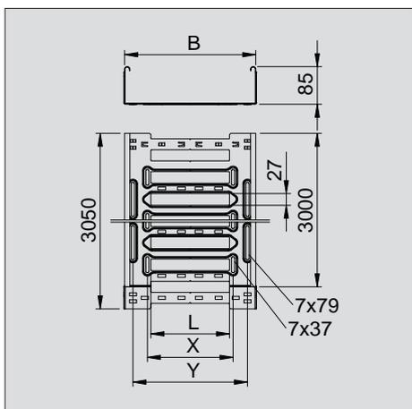
MKSM 85 = Mittelschweres-Kabelrinnen-System-Magic in 85 mm Seitenhöhe. Kabelrinne mit Schnellverbindungs-System, inklusive aller relevanten Verbindungsbauteile zur zeitsparenden und wirtschaftlichen Installation, mit gesickter Längsbohlenlochung 7 x 79 mm zur Auslegermontage. Alle Breiten mit Quersickung zur Stabilisierung und Kabelbelüftung. Durchgängige Seitenlochung 7 x 20 mm als zusätzliche Verbinderlochung.
