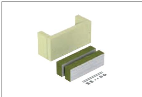
Zugentlastung als wirksame Unterstützungsmaßnahme für senkrechte Kabelverlegung nach DIN 4102 Teil 12, für alle Kabeltypen und alle senkrechten Verlegesysteme zugelassen. Funktionserhaltklassen E30 bis E90. Gehäuse inkl. Mineralfaserplatten, Befestigungsmaterial, Kartusche mit Brandschutzbeschichtung ASX und Kennzeichnungsschild.
