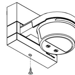
6. Zur Sicherung des Gerätes gegen unerlaubtes Öffnen kann an der Geräteunterseite die mitgelieferte Schraube eingesetzt werden.
