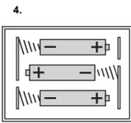
4. Legen Sie die beiliegenden Batterien vom Typ AAA ein. Achten Sie dabei auf die richtige Lage der Batteriepole. **Verwenden Sie beim Batteriewechsel keine Zink-Kohle Batterien!** Insert the enclosed type AAA batteries. Pay particular attention to the battery poles. **Do not use zinc-carbon batteries as replacement!** Plaats de meegeleverde AAA-batterijen. Let daarbij op de juiste polariteit van de batterijen. **Vervang deze niet door zink-koolbatterijen!**
