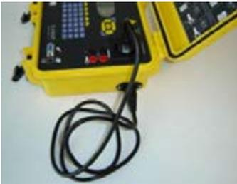
Mit Hilfe einer zusätzlichen Kaltgerätesteckdose können Kaltgeräteanschluss- und Verlängerungsleitungen automatisch, mit Berücksichtigung der erweiterten Messwerte, überprüft werden.
