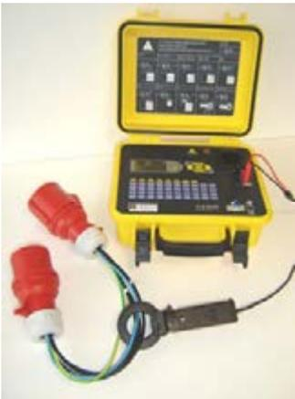
Mit Hilfe einer als Option lieferbaren Stromzange, lassen sich Fehlerströme direkt an fest angeschlossenen Geräten messen. Somit wird ein lästiges abklemmen des Prüflings verhindert.
