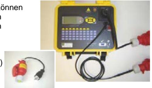
Mit diesen Adaptern wird sowohl der Schutzleiterwiderstand als auch die Isolation L1, L2, L3 und N gegen PE sowie die Durchgängigkeit und Phasenfolge der Verlängerungsleitung geprüft
