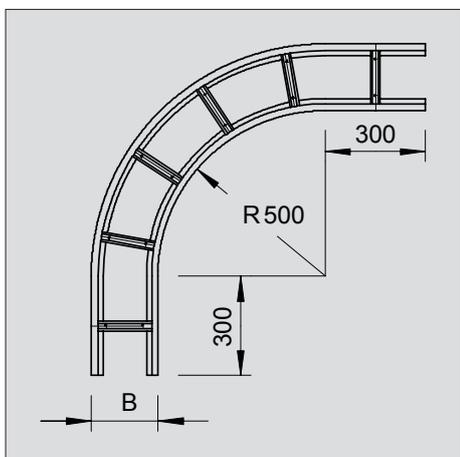
Bogen 90°, horizontal, für alle Weitspannkabelleitern mit der Seitenhöhe 110 mm. Zur weiteren Stabilisierung sollten im Bereich der Formteile Unterstützungen vorgesehen werden.
