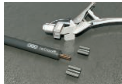
6. Durch Drehen der Zange äußeren Mantel ablösen
