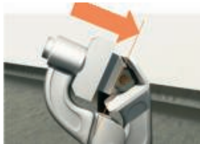
2. Schnitttiefe der Zange einstellen (Kupferseele darf nicht eingeschnitten werden)
