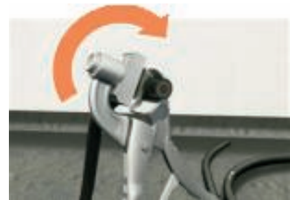
3. Zange ansetzen und nach 25 mm Mantel einschneiden, dann um 360° drehen
