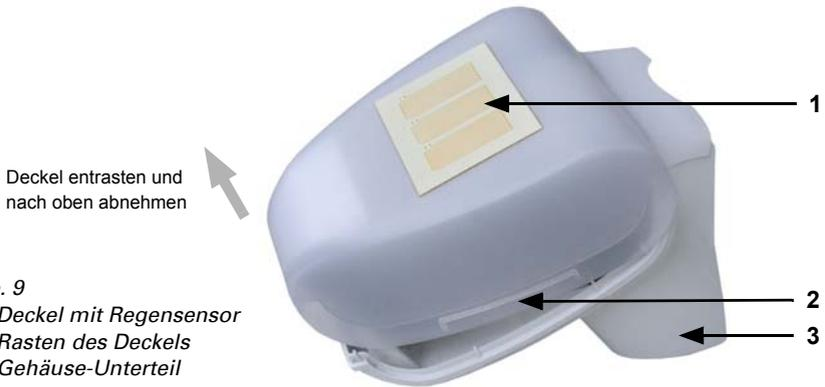
Der Deckel der Wetterstation mit dem Regensensor ist am unteren Rand rechts und links eingerastet (siehe Abb. 9). Nehmen Sie den Deckel von der Wetterstation ab. Gehen sie sorgfältig vor, um die Kabelverbindung zwischen der Platine im Unterteil und dem Regensensor im Deckel nicht abzureißen (beim 230 V AC-Modell gelötete Kabelverbindung, beim 24 V DC-Modell Kabel mit Stecker).
