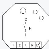
**1 Schließer potenzialfrei 10 A/250V AC, Glühlampen 2000 Watt, Rückfallverzögerung mit Ausschaltvorwarnung und Taster-Dauerlicht zuschaltbar. Verschlüsselter Funk, bidirektionaler Funk und Repeater-Funktion zuschaltbar. Stand-by-Verlust nur 0,8 Watt.**
