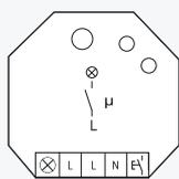
**1 Schließer nicht potenzialfrei 10A/250V AC, Glühlampen 2000 Watt, Rückfallverzögerung mit Ausschaltvorwarnung und Taster-Dauerlicht zuschaltbar. Verschlüsselter Funk, bidirektionaler Funk und Repeater-Funktion zuschaltbar. Stand-by-Verlust nur 0,8 Watt.**
