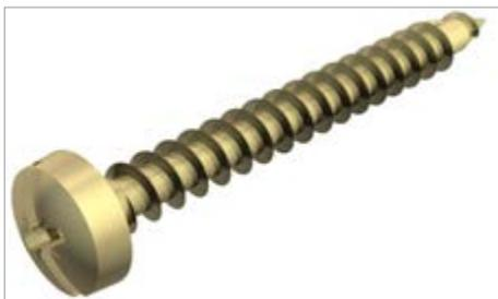
Stahl gehärtet, galvanisch verzinkt und gelb passiviert, sowie hostaflonbeschichtet, Panhead mit kombiniertem Kreuz- und Schraubendreherschlitz (Poqidrive Gr. 2 außer Ø 6 mm Poqidrive Gr. 3).
