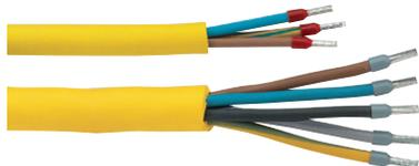
Industrielle Gummischlauchleitung H07RN-F von sehr hoher Qualität. Diese Leitung wurde speziell für die Anforderungen auf Baustellen und im Stahlbau entwickelt. Sie weist eine hohe Resistenz gegen Schweißperlen und Funkenflug auf. Weiters ist sie gekennzeichnet durch hohe Flexibilität, Öl-, Fett-, Säuren- und Laugen- sowie Ozon- und Witterungsbeständigkeit, hohe mechanische und thermische Belastbarkeit. Beste Einreiß- und Weiterreißbeständigkeit.
