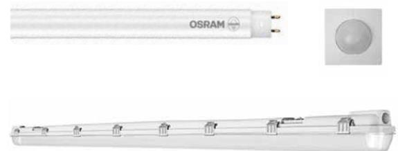
**LED TUBE T8 CONNECTED** LED-Röhre, verbaut in einem robusten **DAMP PROOF-Gehäuse** (IP65), wird drahtlos verbunden mit **LEDVANCE CONNECTED SENSOR ST8 LOW BAY** über ZigBee. Die 2-Stufen-Dimmung (0 % ⇄ 100 % und 20 % ⇄ 100 %) erhöht die Effizienz noch weiter.
