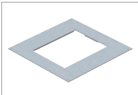
Montagedeckel für Unterflur-Zug- und -Abzweigdosen vom Typ UZD350-3 zum Einbau einer Einbaueinheit der Nenngröße 6. Einbauöffnung 3 mm vertieft zum nachträglichen Blindverschluss mit Deckelblindplatte.
