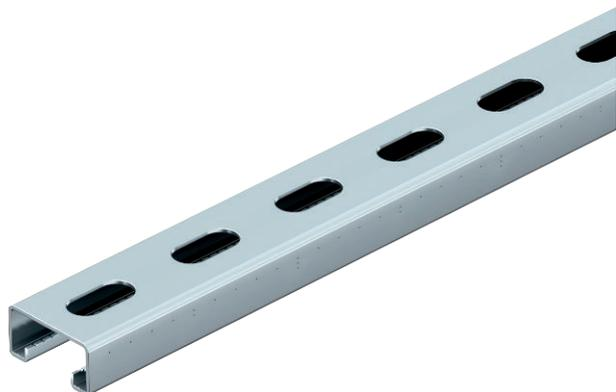
Leichte C-Profilschiene zur individuellen Installation von Tragkonstruktionen für z.B. Kabelrinnen oder als Konsole für Schaltschränke. Auch verwendbar zur Kabelverlegung in Verbindung mit Bügelschellen mit U-Fuß. Lochbild 11 x 28 mm.
