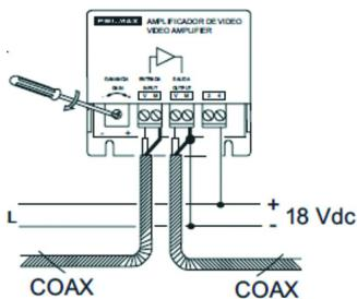
FERMAX Koax-Video-Verstärker f. Leitungslängen über 250m
