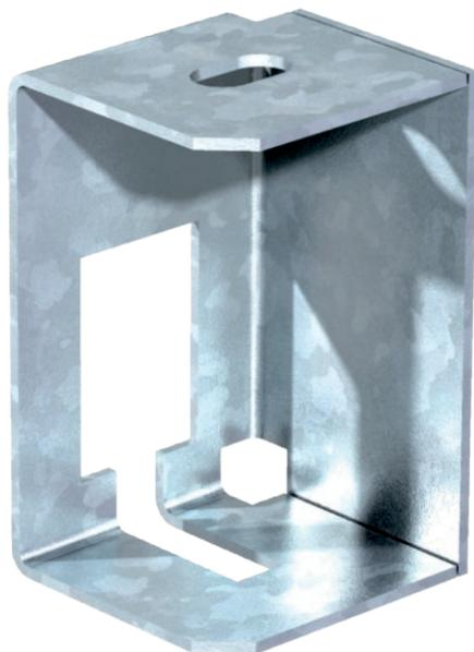
Brandschutzbügel zur Deckenbefestigung der Gewindestangensicherung bei den Verlegearten mit Kabelleitern und Kabelrinnen für den Funktionserhalt nach DIN 4102 Teil 12 und für die Verlegeart mit Kabelrinnen oberhalb von Brandschutzdecken.
