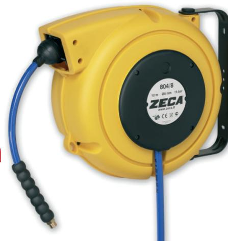
Schlauchaufroller 804 AIR Robuster Industrieroller / 15 bar • Schlagzähes Kunststoffgehäuse • Schwenkbarer Montagebügel • Schlauch-Rücklaufsperre mit Zahnarretierung alle 50 cm. Leicht auszuschalten, falls der Schlauch kontinuierlich unter Anspannung sein soll. • Schlauchtype: widerstandsfähiger Polyurethanschlauch • Zuleitung 1,5 m • Einsatztemperatur -5° C / +40° C
